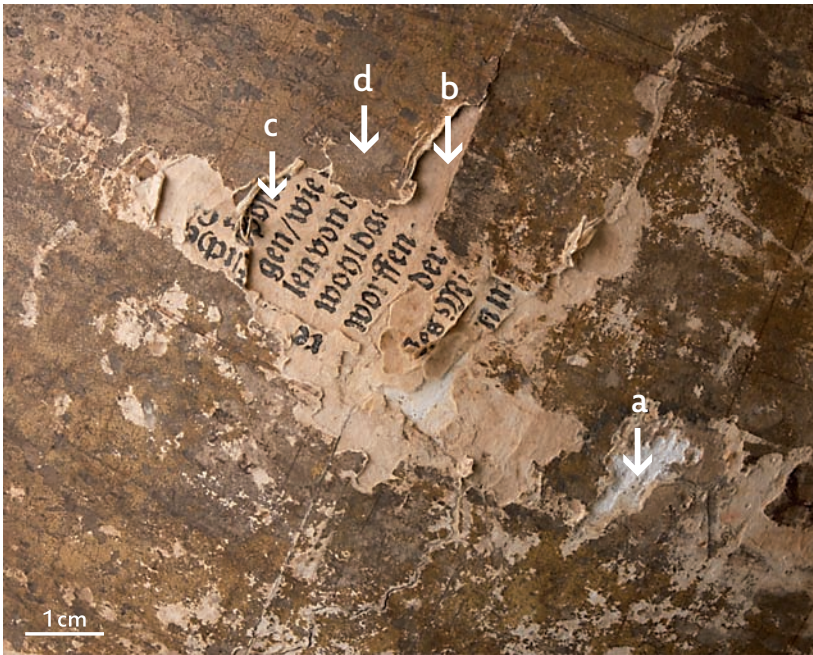
Abb. 8 Schichtaufbau des Erdglobus (Ausschnitt): Gipsgrundierung (a), Makulaturpapiere (b–c) und Papier mit Globuskarte (d).
