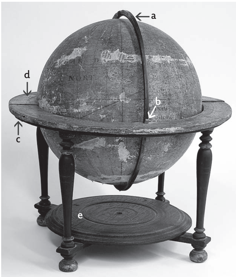
Abb. 7 Halterung einer Globuskugel: Meridianring (a), ruhend in Aussparungen (b) in der Horizontringbasis (c) mit darauf montiert dem Horizontring (d), gehalten von dem Globusgestell (e).
