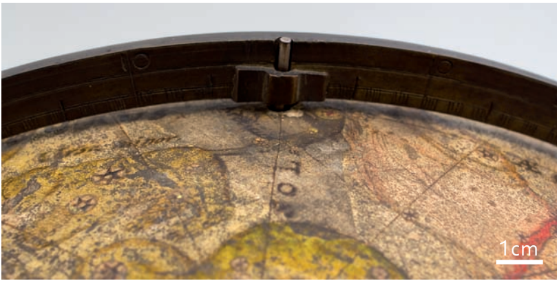
Abb. 17 Himmelsglobus, Detail des Nordpols mit ergänztem Achsstift.
