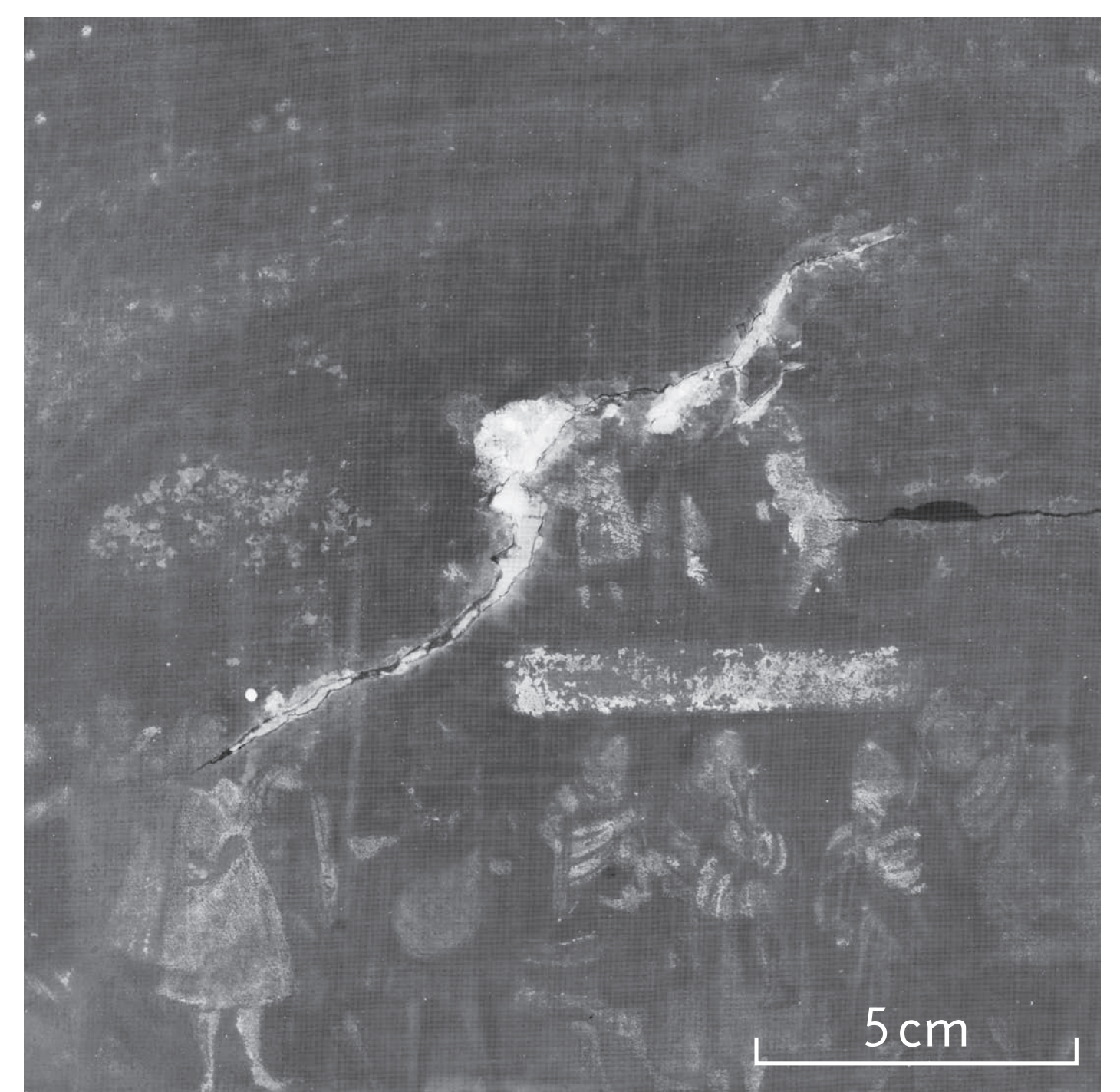
Abb. 7: Röntgenbild der Kittung im oberen linken Bildbereich (vgl. Abb. 6). Die Kittmasse erscheint als dichte, weiße Schicht. Sie besteht vermutlich aus einer Mischung von Gips oder Kreide mit einem Bindemittel wie tierischem Leim.
