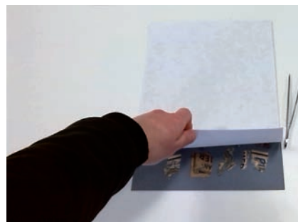
Abb. 10 Tableau aus Wellpappe (dunkelgrau) mit Fragmenten; Filterpaper wird aufgelegt. Foto: Philine Schneider, 2020
